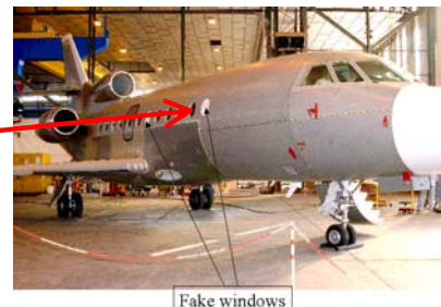
Figure 2 Mesure en vol des interspectres des pressions pariétales extérieures (projet Européen "ENABLE")
